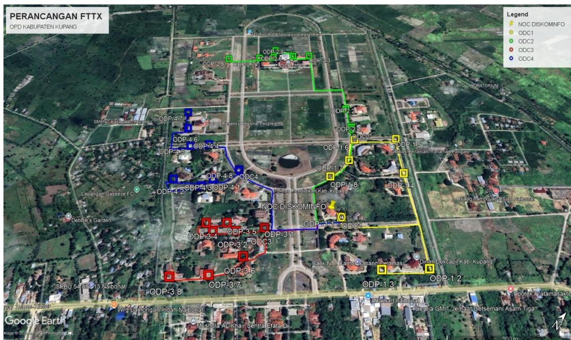
Gambar 4. Rencana jalur backbone dan sebaran perangkat pasif
